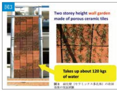
▲緑化壁(セラミックス多孔体)の冷却効果の実証試験
